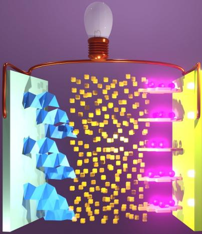
Cuando la pila está cargada, o lista para usarse, los átomos de litio están en el ánodo que normalmente es un material en forma de láminas, como si fueran "pits" de salida para una
